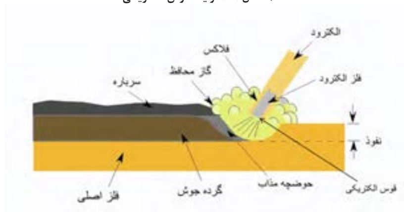
ب) شکل ۳-۴ فرایند قوس الکتریکی را نشان می دهد.
